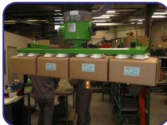
Sondersaugfuß für das Heben von vier Kartons à 25 kg von der Rollenbahn auf die Palette
