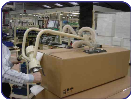
Individuelle Griffführung für sonderformatige Kartonabmessungen
