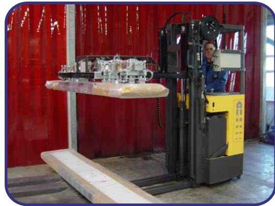
Stapleradaptierbares Vakuumhebeegerät für in Folie eingestreckte Kartons. Netzunabhängige 24V-Ausführung.
