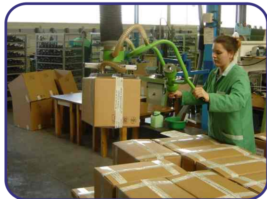
stufenlos abwinkelter Manipuliergriff für ergonomisch günstige Bedienposition auch bei extremen Aufnahme- Ablagehöhen
