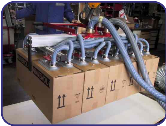
Vakuumhebeegerät zum Abstapeln ganzer Lagen Kartons. bis 200 kg
