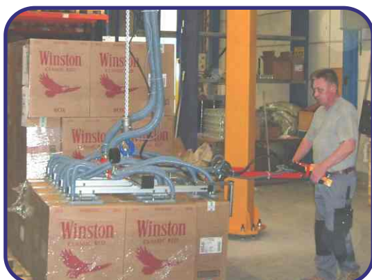
Hebeegerät zum Heben von 10 Kartons à 20 kg mit externer Vakuumzeugung
