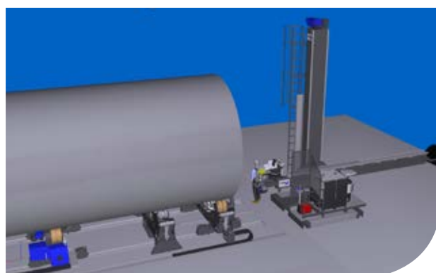
6. Ukończona konstrukcja może być przemieszczona na tych samych wózkach szynowych w miejsce wykonywania prac wykończeniowych i ostatecznej kontroli jakości spoin.
