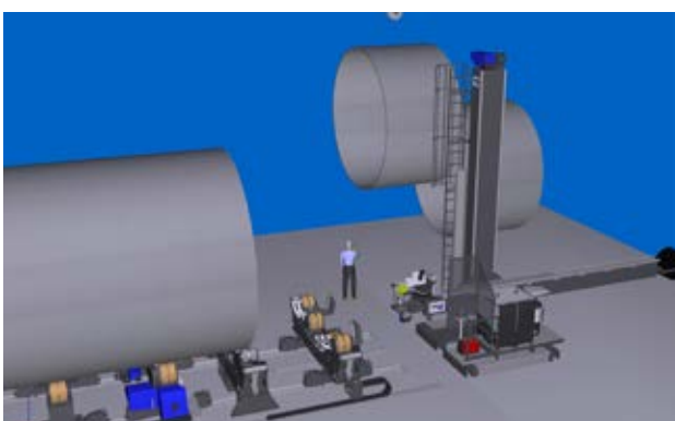
5. Zespawane zwijki odjeżdżają od słupowysięgnika na wózkach szynowych. Kolejna zwijka jest stawiana na stanowisku montażowym, i tak dalej, aż do osiągnięcia pełnej długości konstrukcji.
