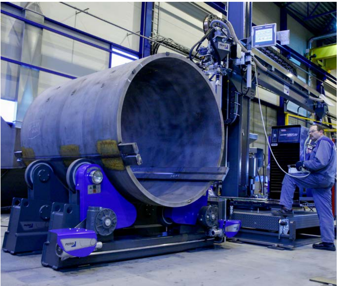
Obrotniki rolkowe PEMA w połączeniu ze słupowysięgnikami PEMA rozwiązują najbardziej trudne problemy automatyzacji spawania
