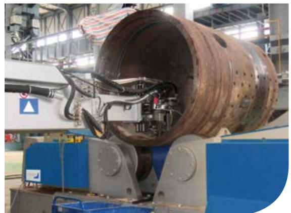
Spawanie wykonywane za pomocą słupowysięgnika i zestawu ciężkich obrotników rolkowych serii N produkcji PEMA
