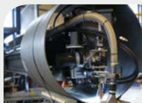
Kompaktowa głowica Single SAW, min średnica 600 mm Specjalna głowica spawalnicza do elementów o małej średnicy. Odpowiednia do spawania obwodowego i wzdłużnego. Śledzenie spoiny dostępne jest jako opcja.
