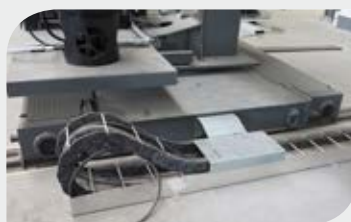
Łączuch kablowy do prowadzenia przewodów podczas jazdy po szynach.
