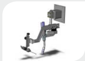
Głowica spawalnicza do spawania MIG/MAG Zaprojektowana do najnowszych metod spawania MIG/ MAG. Urządzenie do spawania oscylacyjnego jest również dostępne jako opcja.
