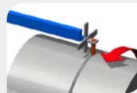
Wewnętrzne lub zewnętrzne spawanie obwodowe
