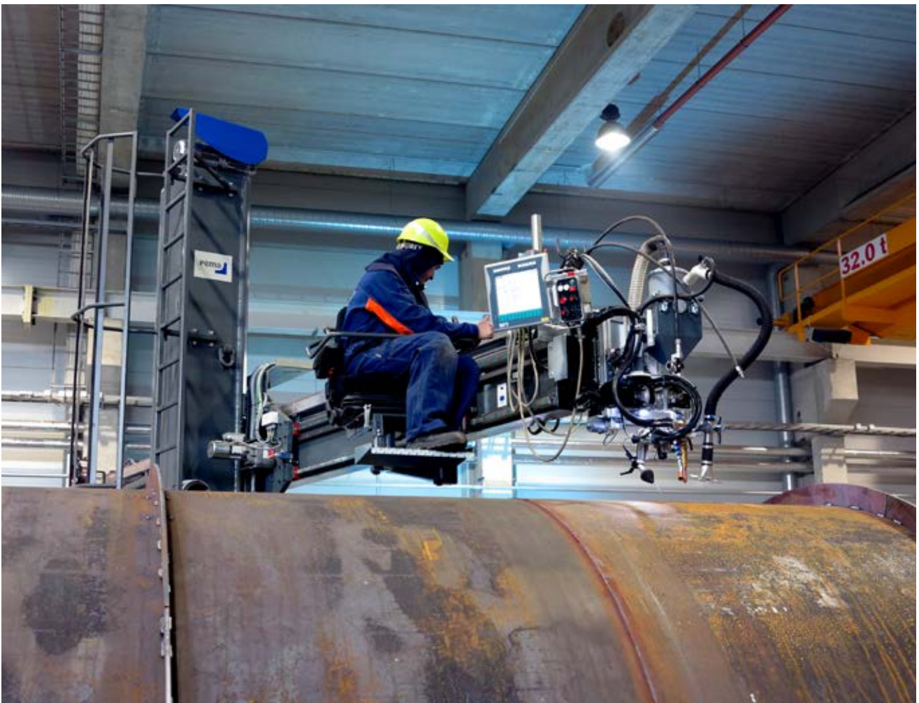
Spawanie słupowysięgnikiem PEMA wyposażonym w układ sterowania PEMA WeldControl 100
