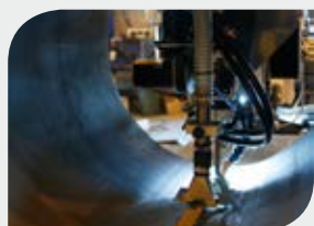
Kompaktowa głowica Tandem SAW Specjalna głowica dwupalnikowa do elementów o małej średnicy. Odpowiednia do spawania obwodowego i wzdłużnego. Śledzenie spoiny dostępne jest jako opcja.
