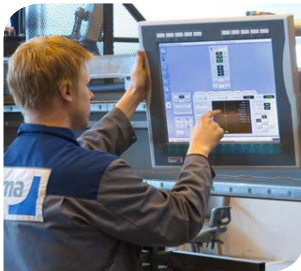
System PEMA WeldControl 500 integruje sterowanie wszystkimi ruchami i innymi parametrami pracy stanowiska w jednoznaczny, łatwy w obsłudze panelu.
